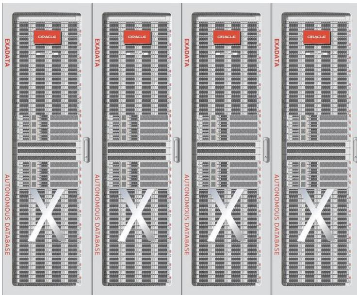
当需要大存储容量时，可以利用 **Oracle Exadata X9M 存储扩展机架**进行扩展。客户可以使用 Exadata 存储扩展机架来为任何 Oracle Exadata 数据库云平台增加存储容量、OLTP IOPS 和扫描吞吐量。该存储扩展机架专为拥有海量数据的数据库部署而设计，这些数据包括历史或归档数据、备份、文档、图像、XML、JSON 和 LOB。该存储扩展机架使用集成式 RoCE 网络结构连接至 Exadata 数据库云平台，无需设置 LUN 或挂载点，因此只需使用几个简单的命令即可完成配置。Oracle Exadata 存储扩展机架的初始配置包含 4 台存储服务器，用户可添加更多存储服务器来对其进行扩展。
